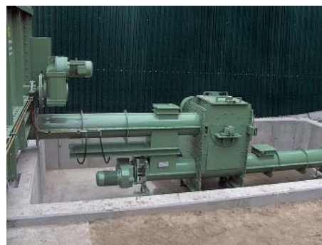
Rozmělňovací technologie integrovaná do dopravní cesty
