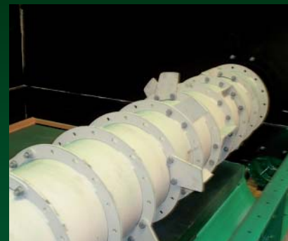
Dávkovací a rozměňovací válec s vyměnitelným nářadím v nerezovém provedení
